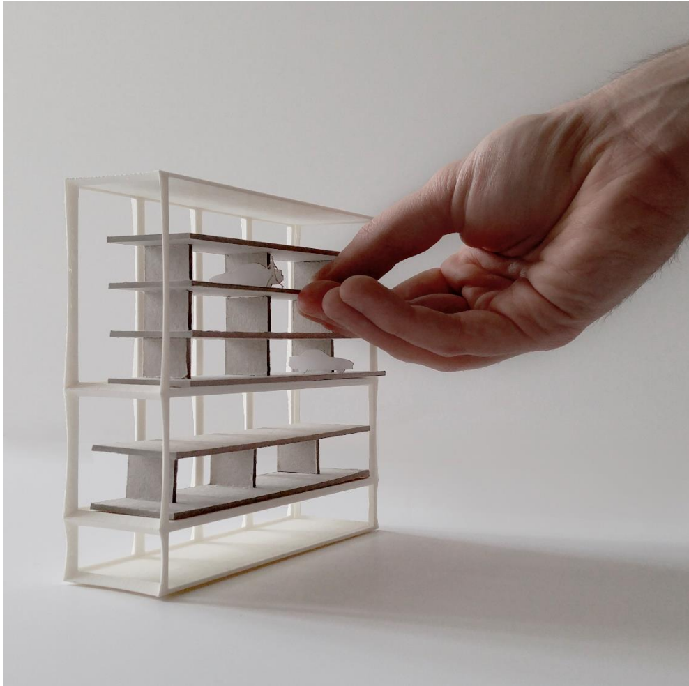
Figure 31 : Maquette 1 :150 représentant la fonction stationnement avec superstructure (béton) + structure secondaire (béton/acier), par l'auteur
